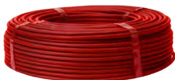
Cable de manguera de par trenzado y apantallado. De color rojo y cobre pulido flexible, clase V de 2x1 mm<sup>2</sup>. Pantalla de cinta de aluminio/poliéster y drenaje de cobre estañado de 0,5 mm<sup>2</sup>. Recomendado para las conexiones RS485 red Noti•Fire•Net e ID2net. Impedancia característica 120 ohmios. No propagador de la llama.
