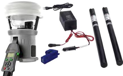
Cabeza de comprobación de detectores electrónica con dosificador de humo y calefactor, controlado por microprocesador. Permite seleccionar el orden de prueba y realizar el barrido con aire de la cámara de los detectores. Leds indicadores de funcionamiento de modo de prueba (Humo, Calor o Limpieza) fallo y batería baja. Dispone de cartucho de pruebas con humo concentrado para generar la correcta dosificación para el test. Incluye batería de reserva y cargador para alimentación o coche.
