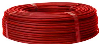
Cable de manguera de par trenzado y apantallado. De color rojo y cobre pulido flexible, clase V de 1,5 mm<sup>2</sup>. Pantalla con cinta de aluminio/poliéster y drenaje de cobre estañado de 0,5 mm<sup>2</sup>. Recomendado para la instalación de los lazos analógicos de NOTIFIER. Resistente al fuego, libre de halógenos, baja emisión de humo y baja corrosividad.
